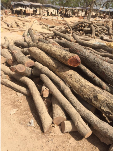
Photo 8 : Bois destiné au soutènement des galeries des puits filoniens (Woyon-daman), Dabalé
