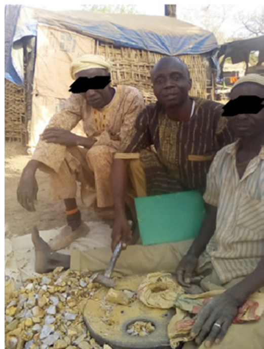
Photo 5 : Orpailleur en train de concasser les pierres contenant des minerais d'or, site de Balandugu
